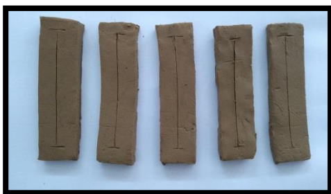
Gambar 9 . Lempengan-lempengan tanah liat untuk diuji persentase susut kering dan susut bakar.
