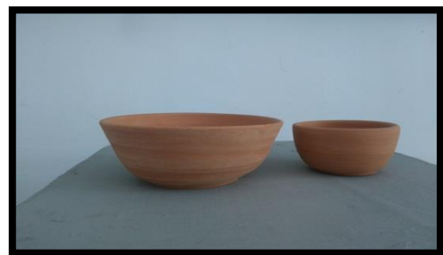
Gambar 12. Sampel karya keramik (mangkok dan souvenir ) dari tanah liat Parit Malintang yang dibuat dengan teknik putar padat setelah dibakar biscuit. (Sumber: Taufik Akbar, 2018)
