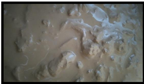
Gambar 5. Tanah liat Parit Malintang berbentuk bubur yang belum disaring (Sumber: Taufik Akbar, 2018)
