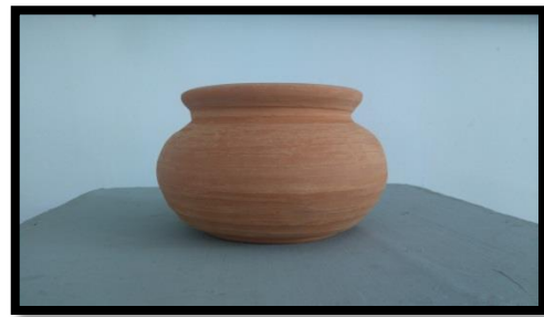
Gambar 11. Sampel karya keramik (vas bunga) dari tanah liat Parit Malintang yang dibuat dengan teknik putar padat setelah dibakar biscuit. (Sumber: Taufik Akbar, 2018)
