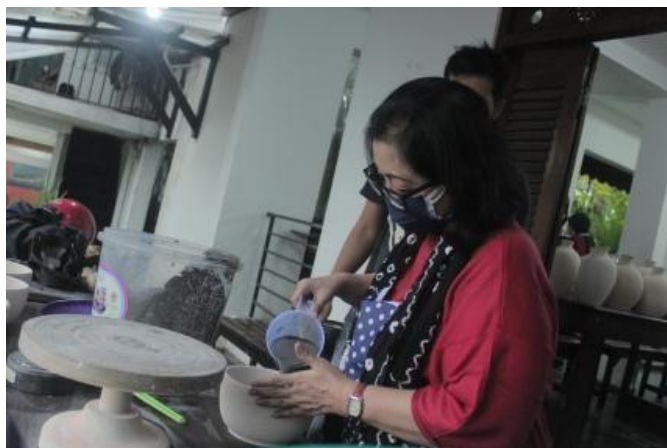
Gambar 2. Proses pelapisan glasir pada karya keramik menggunakan teknik celup. (Sumber: Caecilia Tridjata Suprabanindya, 2024)
