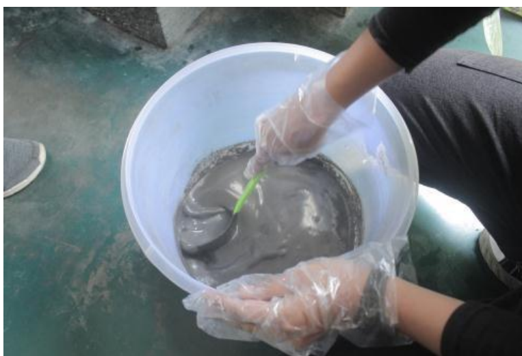
Gambar 1. Pencampuran glasir abu daun nangka secara manual tanpa ball mill. (Sumber: Caecilia Tridjata Suprabanindya, 2024)
