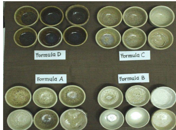
Gambar 4. Sampel uji glasir abu berbentuk mangkuk dengan 4 formula. (Sumber: Caecilia Tridjata Suprabanindya, 2024)
