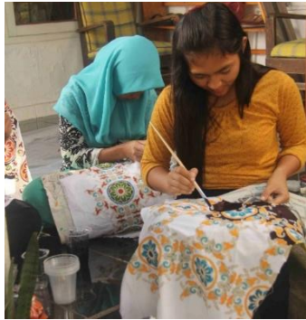
Gambar 8. Proses Pewarnaan kain batik dengan teknik colet
