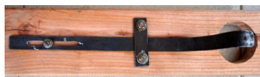
Gambar 25. Posisi Jangka dengan Pengatur dan Pengunci pada bagian bawah Rangka Atas Alat Ukir
