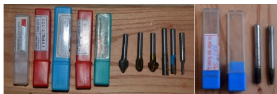
Gambar 20. Jenis-Jenis Mata Router dan Mata Router Engraving yang Dapat Digunakan Dalam Proses Duplikator Ukiran dan Pembuatan Ukiran
