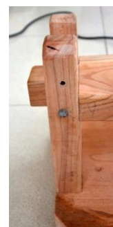
Gambar 24 Pengatur Tinggi Rendah Rangka Atas Dudukan Mesin Router
