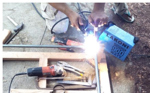
Gambar 3. Pengelasan Dudukan As/Sumbu
