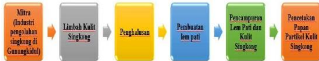
Gambar 3. Tabel Tahapan Pengolahan Limbah Menjadi Papan Partikel (Sumber: Dokumentasi Pribadi)
