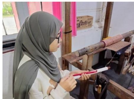
**Gambar 19.** Proses pengulungan benang pakan pada *kasali* kemudian dimasukan kedalam *turak* (Dokumentasi: Viga Fatimah Tuazzara, 2024)
