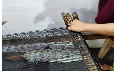
**Gambar 17.** Proses mengikat ujung benang lungsi pada *tandaian* (Dokumentasi: Viga Fatimah Tuazzara, 2024)
