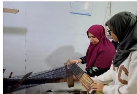
**Gambar 18.** Proses pengulungan benang lungsi pada *tandaian* (Dokumentasi: Viga Fatimah Tuazzara, 2024)
