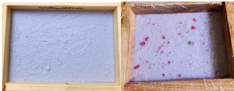
Gambar 3 (a) Bubur kertas dari kertas bekas dan 3(b) dari kertas bekas, ampas tebu dan kulit buah naga (dokumentasi: Hijratur Rahmi, 2023)
