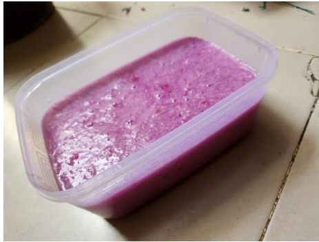
Gambar 2 Bubur kertas dicampur ampas tebu dan kulit buah naga (dokumentasi: Hijratur Rahmi, 2023)
