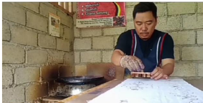
Gambar 2. Proses pembuatan batik cap (Sumber: Macita Sari. 2024)
