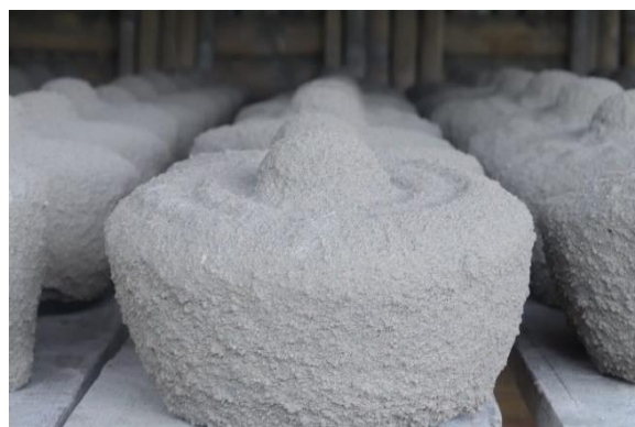
Foto 3. Talilia japan(proses pelapisan tanah liat agak kasar) dan bentuk cetakan setelah kering (foto:Hasrafi Syaiiddil Hasfa28-04-2023)
