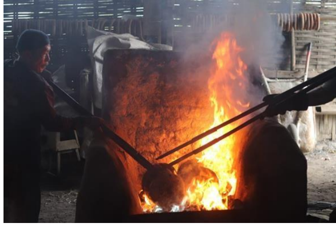
Foto 6. proses melelehkan kuningan dan membakar cetakan foto:Hasrafi Syaiiddil Hasfa28-04-2023)
