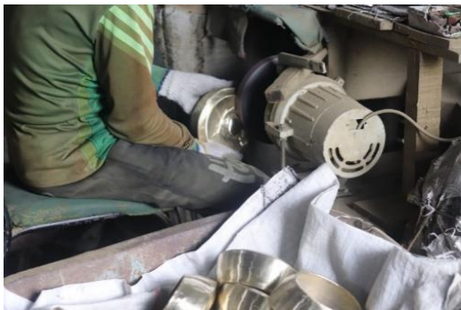
Foto 7. proses mempolish permukaan talempong foto:Hasrafi Syaiiddil Hasfa28-04-2023)
