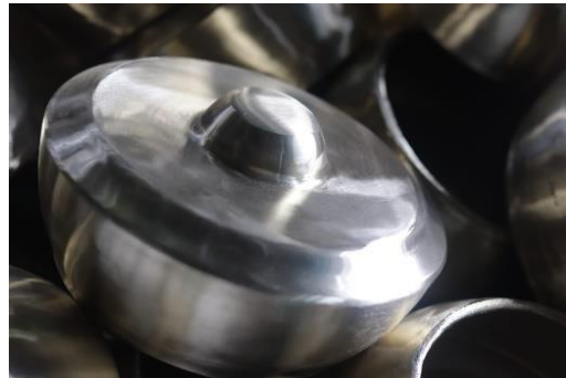
Foto 7. proses mempolish permukaan talempong foto:Hasrafi Syaiiddil Hasfa28-04-2023)
