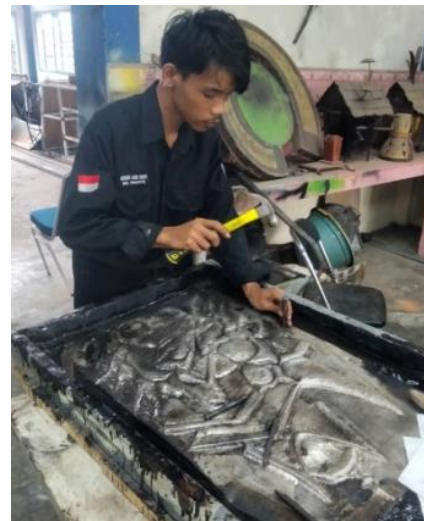
Gambar 10. Proses memahat logam dengan teknik tatah (Aldi Wahyudi, 2022)
