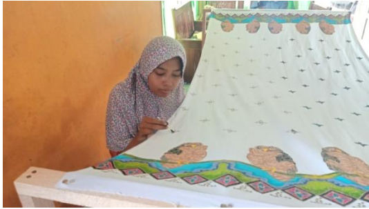
Gambar 12. Pencoletan remazhol dengan cotton bud (Sumber: Serly Rizki, 2022)
