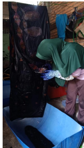
Gambar 16. Mencelup ke larutan naphthol (Sumber: Serly Rizki, 2022)
