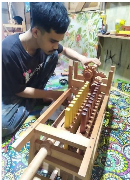
Gambar 8 Merangkan dan melumasi komponen Sumber: Dokumentasi pribadi
