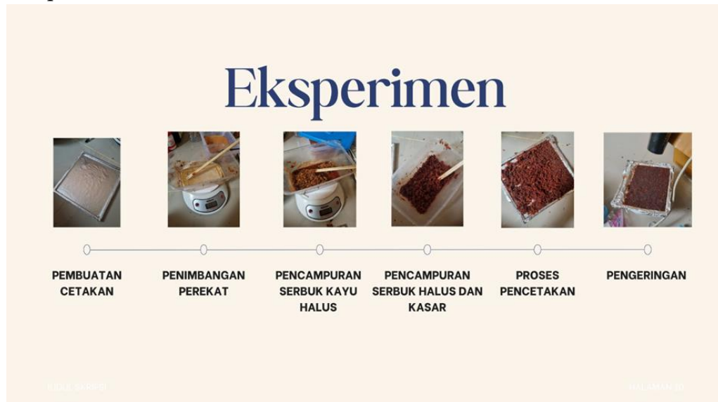
Gambar 7. Eksperimen pengolahan limbah serbuk kayu
